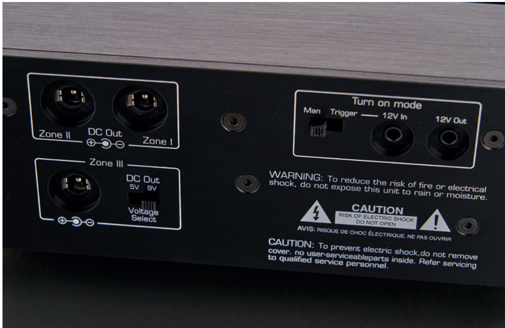
Für Zone III lässt sich zwischen fünf und neun Volt per Schiebeschalter wählen
