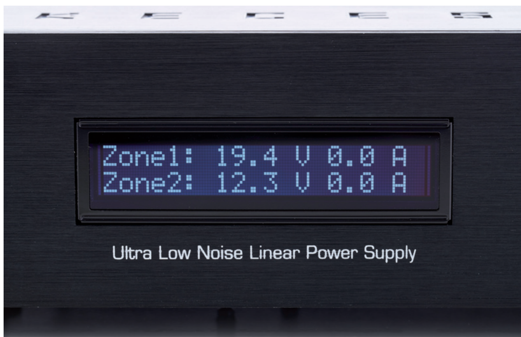
Im Fotostudio ist kein Verbraucher an den Keces P8 angeschlossen, wie die Werte für die Stromaufnahme zeigen. Der SoulM verbraucht übrigens 0,6, der Mytek DAC etwa 1 Ampere
