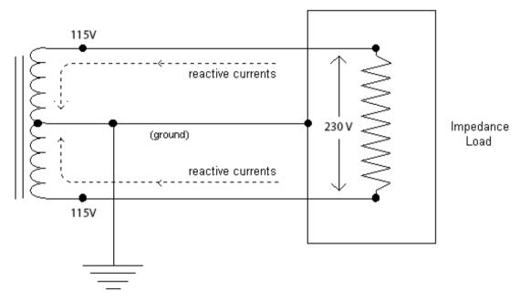
Gehen wir nun zurück zu den Grundlagen und überprüfen den neu konstruierten Wechselstromkreislauf, wo wir die ursprüngliche heiss(P)-neutrale(N) Massepunkt – Architektur zu einer symmetrischen Verschaltung konfiguriert haben. (siehe Graphik darunter) Reaktive Ströme, welche die primäre Ursache für elektrische Interferenzen sind, werden nun symmetrisch ausgewogen am Massepunkt eliminiert.
